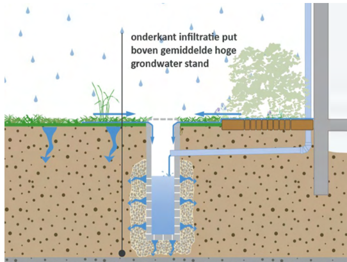
Figuur 12 - Verticale infiltratie
